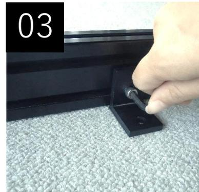
01で合わせたイージーナット4ヶ所に六角穴付きボルトでL字アングルを留める
