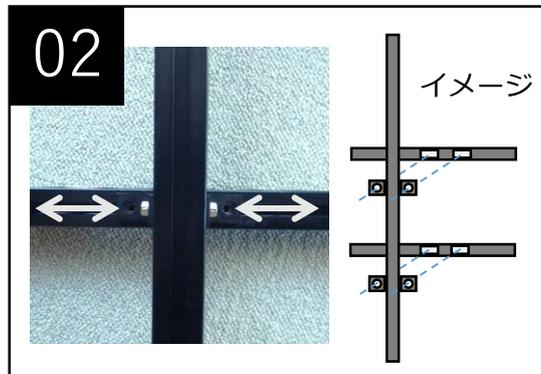
レールにポールをあてL字アングルの穴にイージーナットの位置を合わせる
