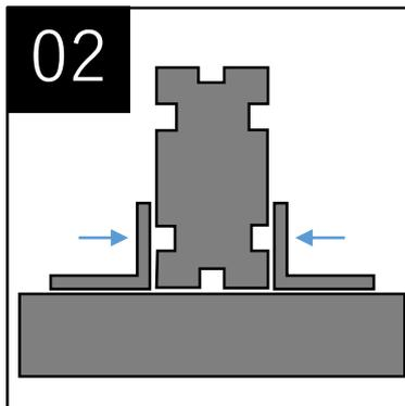
ネジ穴とレールの位置が合うようL字アングルの向きを確認する
