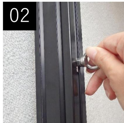
アイボルトにナットを付け、Cに入れたイージーナットに付ける
