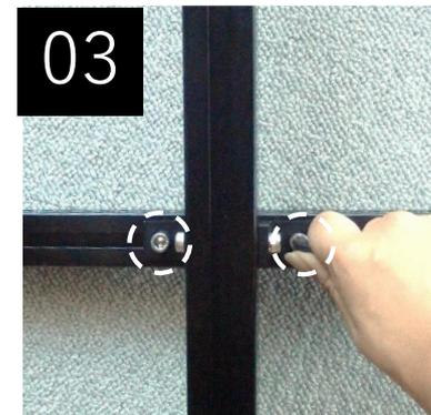
ポールを手で支えながら六角穴付きボルトでポールを取り付ける
