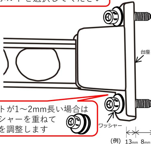
(例)物干し金物の台座の厚みが13mmの場合、ワッシャーを1枚と、22mmの六角穴付きボルトを使用します
